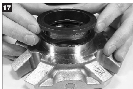
Wyjąć wewnętrzny stacjonarny pierścień uszczelniający z dławika i wyrzucić.
