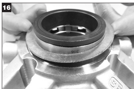
Wyjąć uszczelkę z adaptera i wyrzucić.
