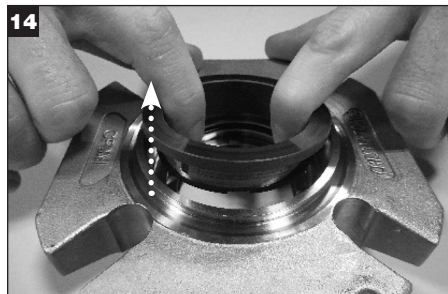
Wyjąć zewnętrzny stacjonarny pierścień uszczelniający z rękawa i wyrzucić.
