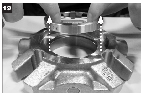
Wyjąć kanał napędu z dławika; wyjąć klamry kanału i deflektor przepływu z kanału i wyrzucić.
